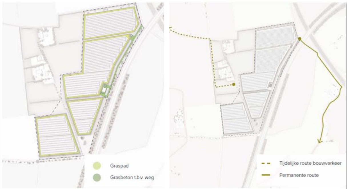
Figuur 2.5. Type paden in het zonnepark (links) en ontsluiting bouwfase en gebruiksfase (rechts).
