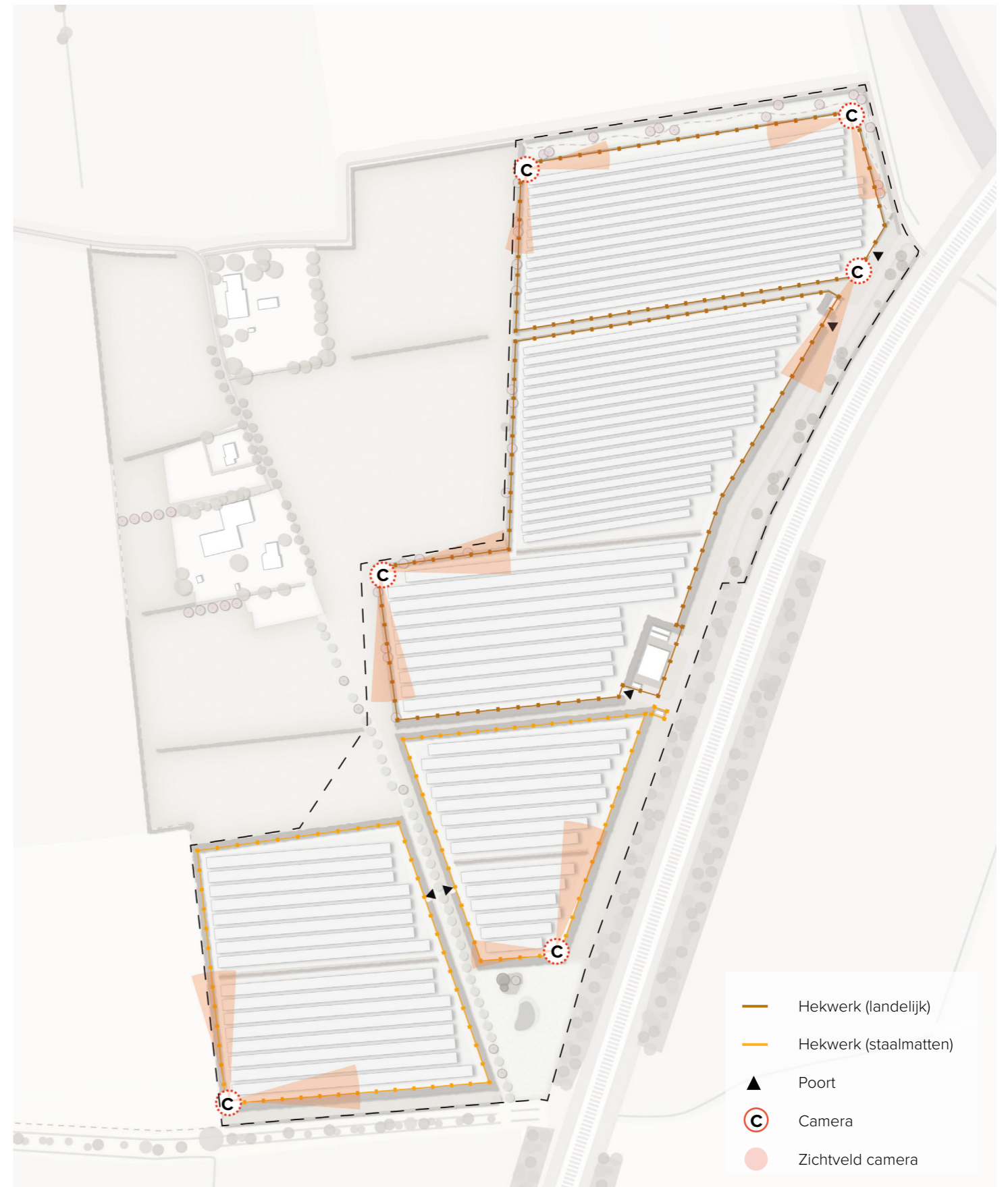
Locatie hekwerken en camera's
