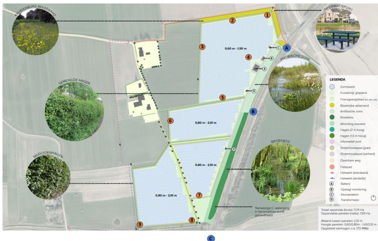
Figuur 1 – Situatieschets zonnepark De Voort met negen referentiepunten (oranje) en drie ontvangstpunten (blauw).
